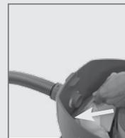
Filtersack in Rille einsetzen
